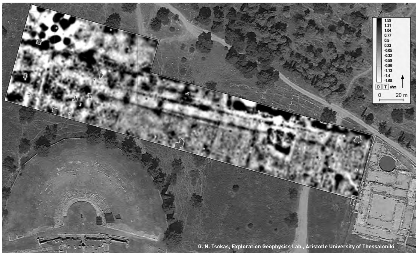
Fig. 12 Érétrie, carte de résistivité électrique des terrains à l'ouest du Gymnase, où l'on distingue deux lignes parallèles
