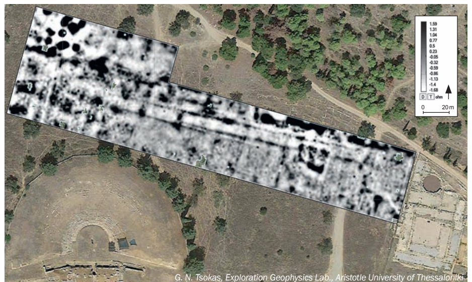
Carte de résistivité électrique des terrains à l'ouest du gymnase, où l'on distingue deux lignes parallèles. Karte des elektrischen Bodenwiderstands im Bereich westlich des Gymnasiums, wo man zwei parallele Linien erkennt.
